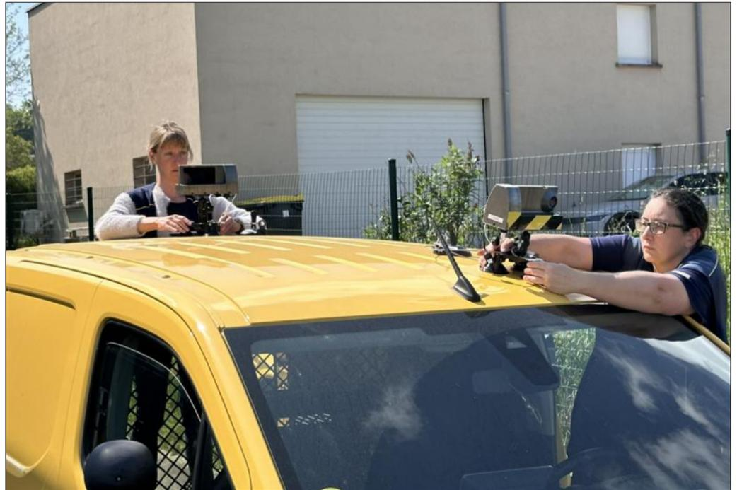
Les deux caméras, l'une à l'avant, l'autre à l'arrière, sont installées à l'aide de ventouses sur le toit de la voiture. Photo ER/Hugo ARLABOSSE
